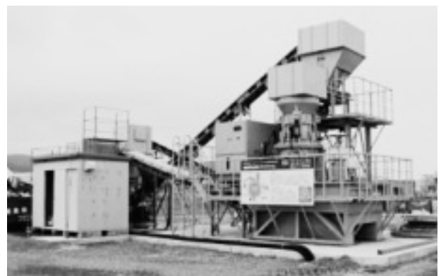
写真-2 機械すりもみ法製造設備 (竹中工務店HPより)
