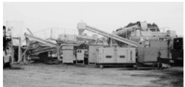
写真-3 スクリュー磨砕方式製造設備 (太平洋セメントパンフレットより)
