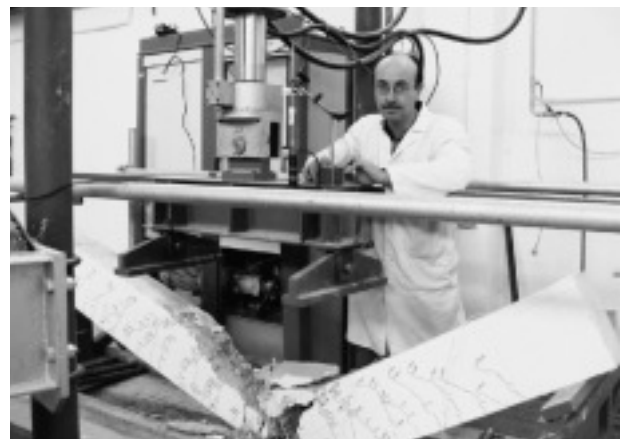
写真-4 BRC 実験室 (FRP 補強コンクリート桁の試験)
