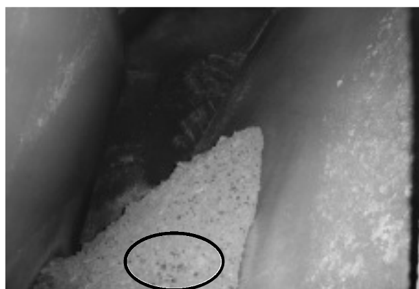
焼却炉ホッパーでの混合状態 (黒い点がエコペレット)
