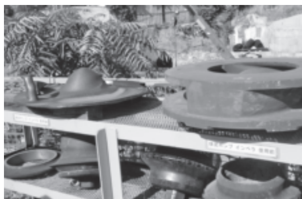
写真19 排泥ポンプ インペラー使用前、使用後
