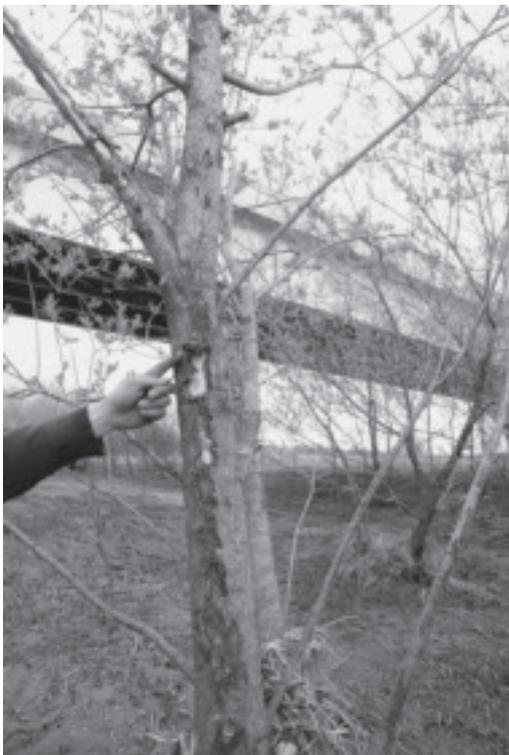
日高自動車道厚真川橋付近の氷板による衝撃痕(河口から2.4 km、衝撃痕平均地上高1.22 m)
