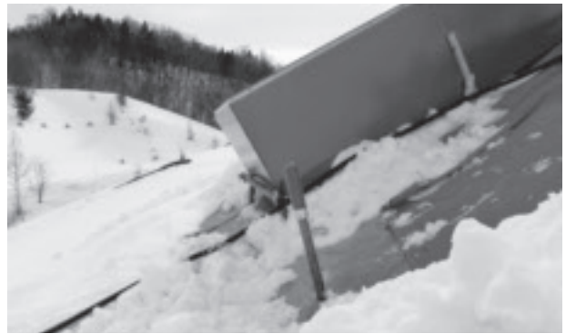
写真-7 Area net傾斜計設置事例(法面崩壊)
