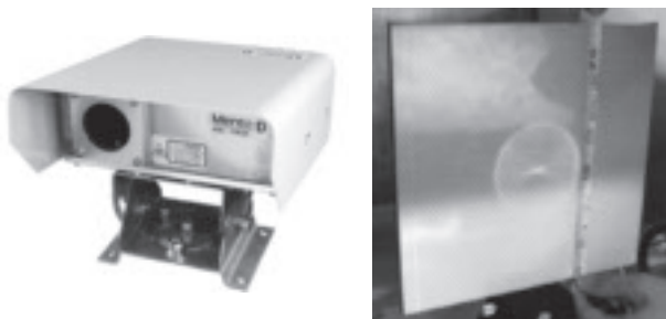
写真-3 「拡散レーザ変位計」本体と拡散させたレーザ光の照射状況
