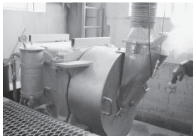
写真-4 リングダイ式のペレタイザ
