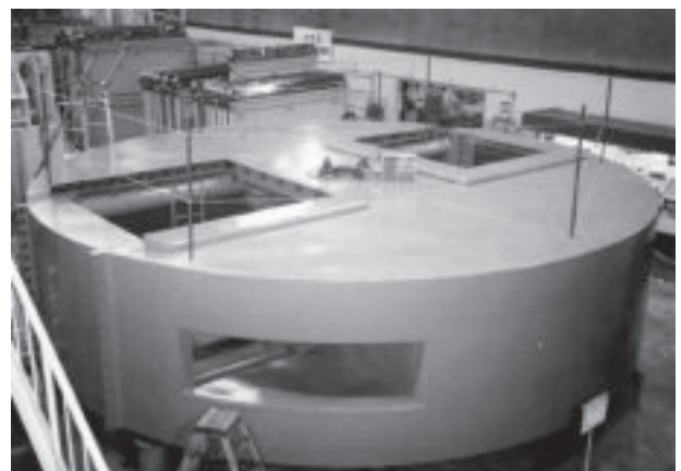
写真-6 岩盤亀裂発生装置 (遠心力载荷装置(2号機))
