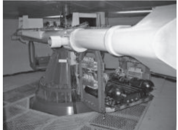
写真-4 遠心力载荷装置(1号機)
