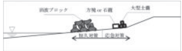
図-2 盛土被害の対策工
