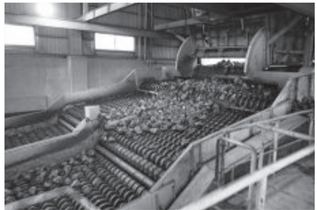
図-2 原料受入～流送工程
