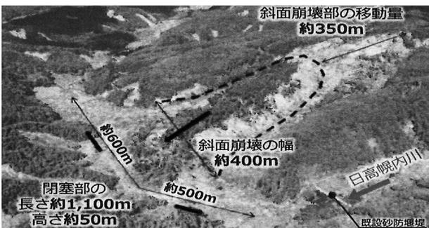
写真-4 河道閉塞の発生状況(北海道開発局 提供資料)
