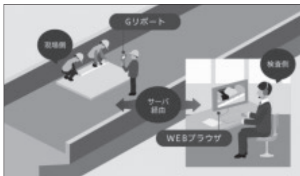
図-11 遠隔臨場検査の仕組み
