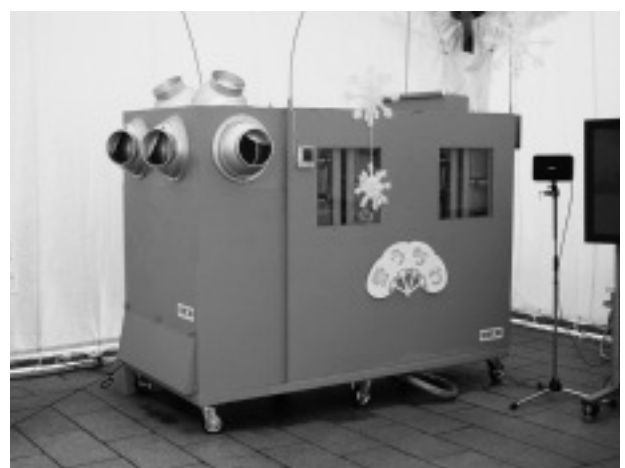
雪冷房装置「雪うちわ」
